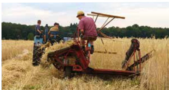
Auf der rechten Seite des Gerätes wird das Getreide geschnitten, auf der linken Seite wird es zu Garben gebündelt und ausgeworfen.
